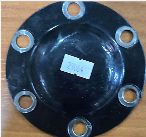
Tapa de eje delantera ; Profi 4x2
