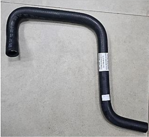
Manguera de agua de calefaccion ; L= 77 cm
