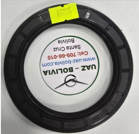
Reten de cubo de rueda ; 75x102x10
