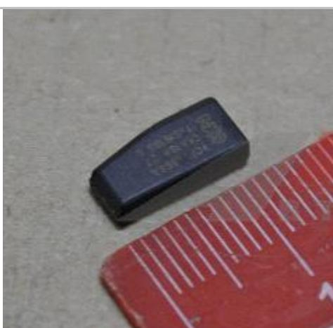
**Chip de inmovilizador para colocar en llave de encendido de motor**
