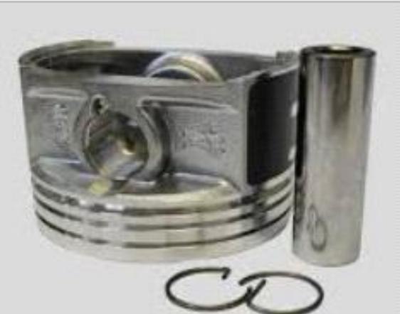
Piston dedo anillos de retencion ; medida 95,5 mm ; Motor ; 4 pistones
