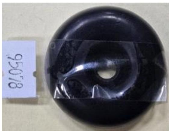
Reten capuchon de cilindro auxiliar de freno
