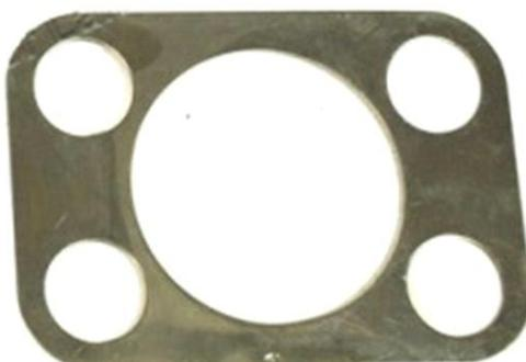
Empaquetadura para ajuste de cubo de rueda ; 0,10 mm
