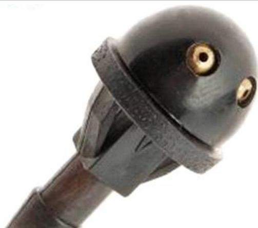
Boquilla de pulverización de agua ; limpiaparabrisas delanteras
