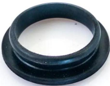
Empaquetadura para tapa de valvulas ; Motor
