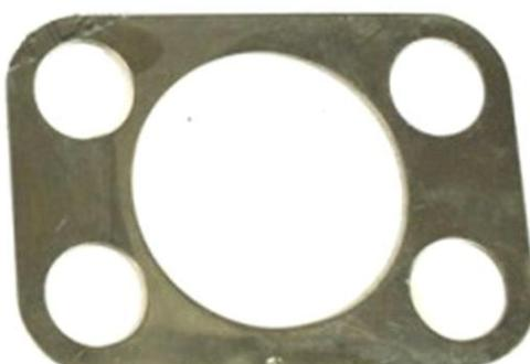
Empaquetadura para ajuste de cubo de rueda ; 0,15 mm
