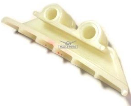
**Amortiguador superior de cadena ; de distribucion en motor ; Motor**
