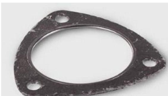
**Empaquetadura para neutralizador - caño de escape**
