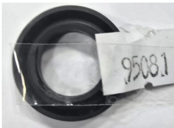
Reten cubeta para cilindro de embrague ; 13,4x23 mm
