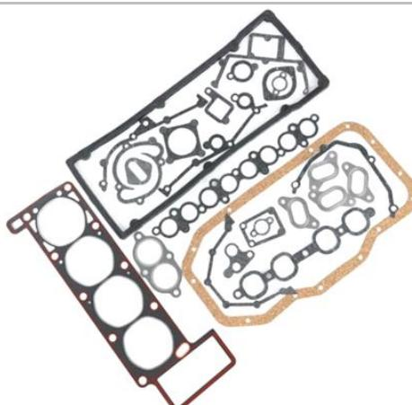
**Empaquetadura para motor ; Motor**
