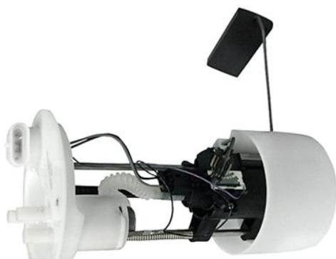
Bomba de gasolina en conjunto ; electrica ; con acoplados para rapida desconexion
