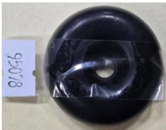
Reten capuchon de cilindro auxiliar de freno
