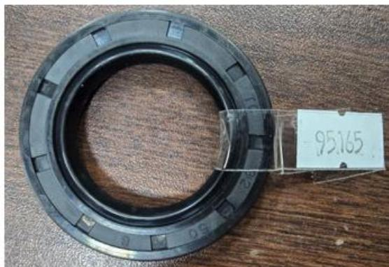
Reten manguito para bisagra de cubo giratorio ; 32x50x8
