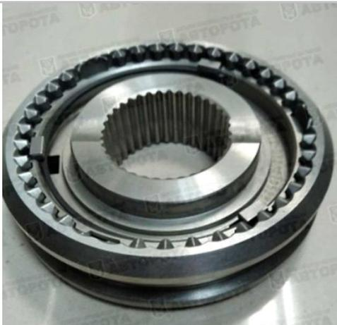
Acoplamiento para caja de cambios - deslizante ; 1-ra y 2-da velocidad ; Caja Baic
