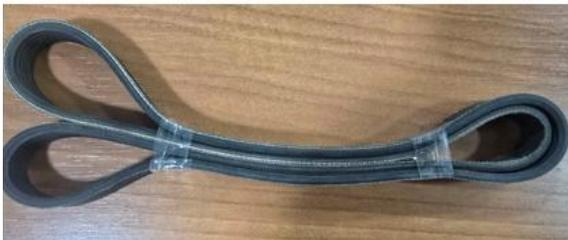
Correa de agregados de motor; sin a/c;
