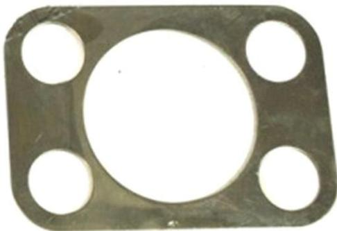
Empaquetadura para ajuste de cubo de rueda ; 0,10 mm
