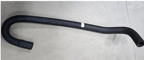
Manguera de liquido refrigerante: de calefaccion interior al motor ; D ext 2,7 cm, D int 1,9 cm
