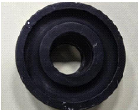
Rodillo de tensión de correa de agregados de motor
