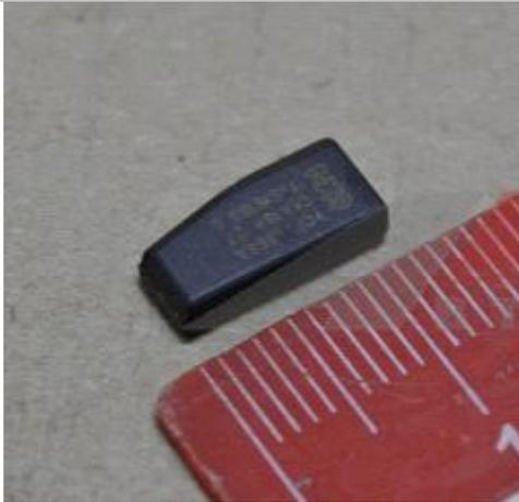
Chip de inmovilizador para colocar en llave de encendido de motor
