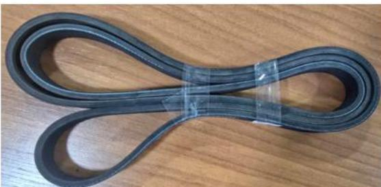
Correa de agregados de motor; sin a/c; L=172 cm ; 6pk1725
