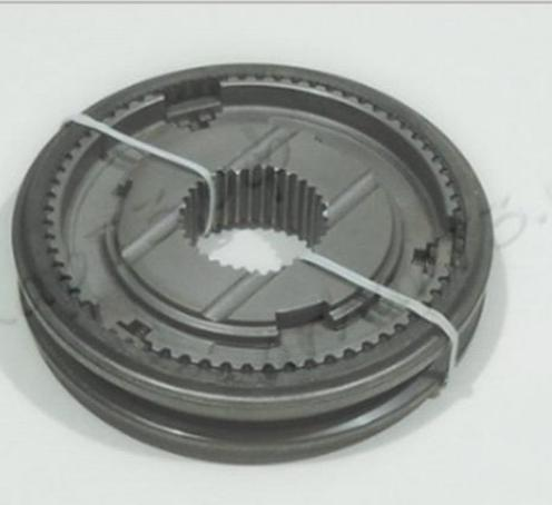
Acoplamiento para caja de cambios - deslizante ; 3-ra y 4-ta velocidad ; Caja Dymos
