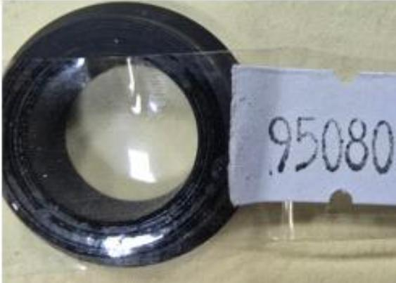
Reten cubeta para cilindro de embrague ; 13x23 mm
