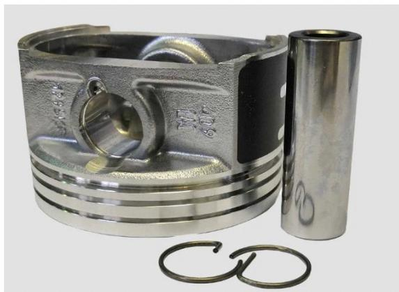
Piston dedo anillos de piston anillos de retencion ; medida 96 mm; Grupo B ; Motor ; 4 pistones
