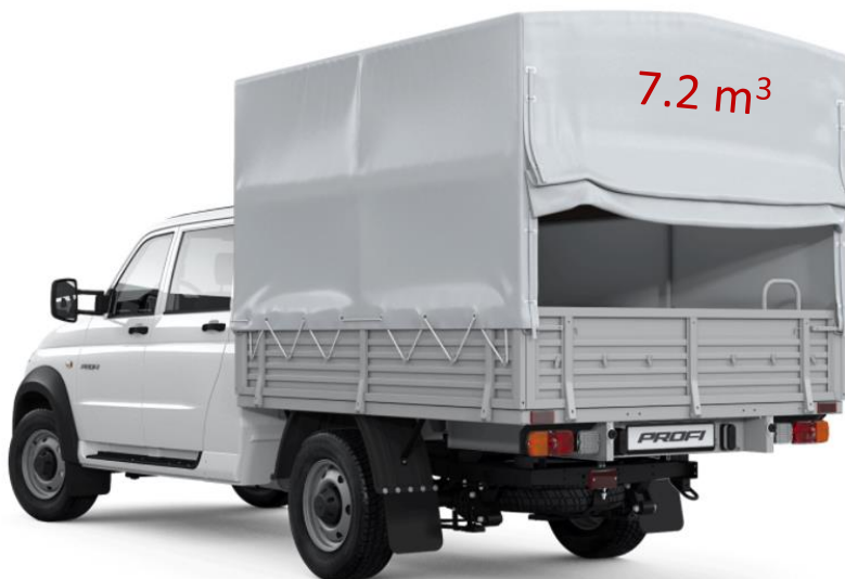
Cabina doble; Tracción 4x4; Modulo de carga 2350 x 1870 mm (7,2 m 3 ); Vehículo: longitud - 5.99 m, anchura - 1.99 m, peso - 2225 kg
